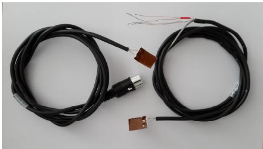
Рисунок 3 – термопреобразователи сопротивления ТСП 9715 в сборе
