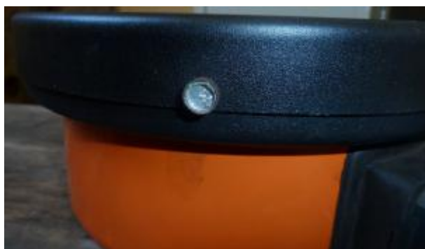
Рисунок 3 – Место пломбировки от несанкционированного доступа
