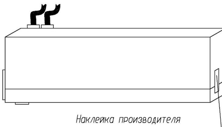
Рисунок 4 – Схема пломбирования вычислителя ВРФ
