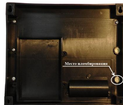
Рисунок 6 – Пломбирование тепловычислителя СПТ943
