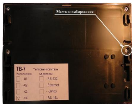
Рисунок 4 – Пломбирование тепловычислителя ТВ7
