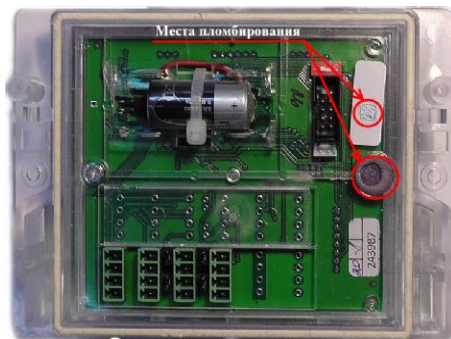
Рисунок 5 – Пломбирование тепловычислителя ВКТ-7
