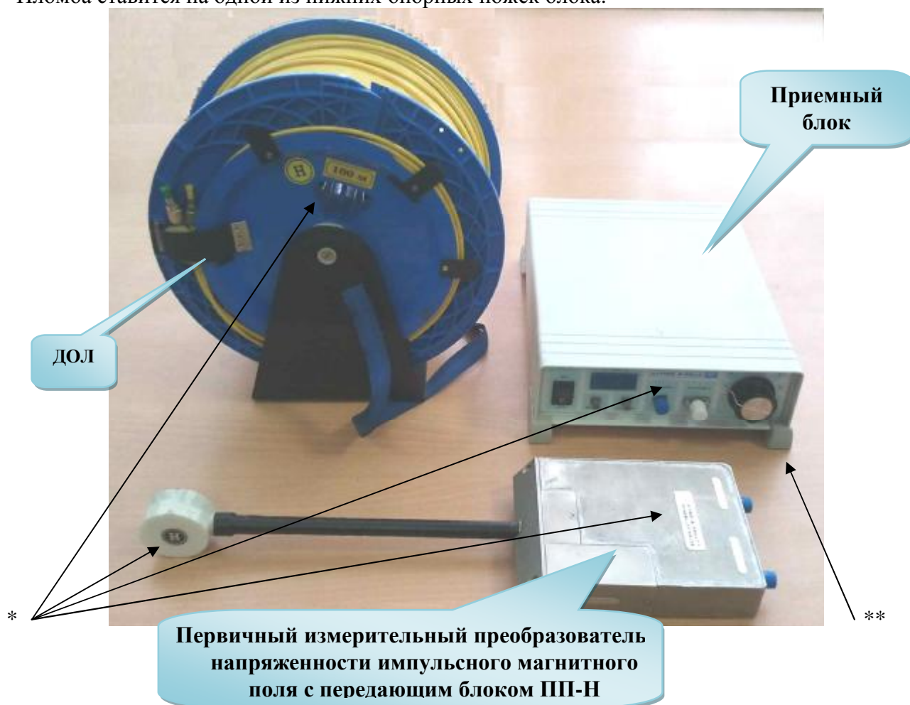
Рисунок 1 - Общий вид составных частей канала ИМП, его маркировка и схема пломбирования от несанкционированного доступа * - маркировка, ** - место установки пломбы
