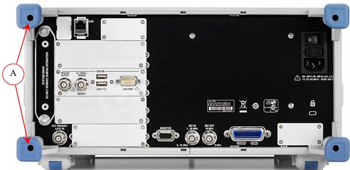
Рисунок 2 - Схема пломбировки от несанкционированного доступа (А)
