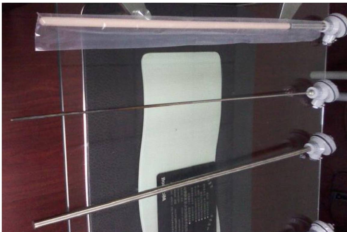
Рис. 1 Вид термоэлектрических преобразователей SY (сверху вниз модификации SY-WRP2, SY-WRNK2, SY-WRN2)
