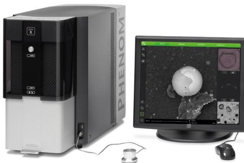
Рисунок 1 – Общий вид микроскопа электронного растрового настольного PHENOM
