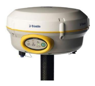
Пломбирование крепежных винтов корпуса аппаратуры геодезической спутниковой Trimble R4-3, Trimble R6-4, Trimble R8-4 не производится, все внутренние крепежные винты залиты пломбирующим лаком.
