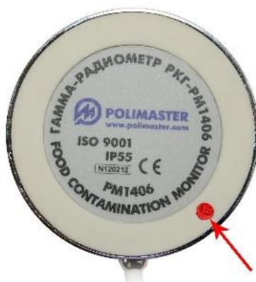
Рисунок 2 - Место пломбирования гамма-радиометра РКГ-PM1406 от несанкционированного доступа (находится на основании радиометра)
