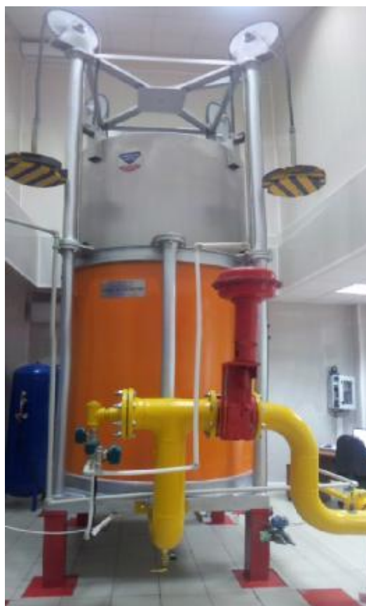
Рисунок 1 – Общий вид установки поверочной колокольной КПУ-2000
