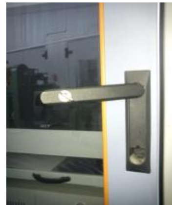
Рисунок 4 – Внешний вид замка на дверце стойки управления
