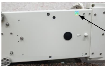
Рисунок 2 – Схема пломбирования весов от несанкционированного доступа
