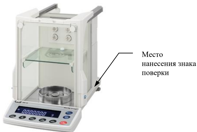
Рисунок 1 – Общий вид весов и обозначение места нанесения знака поверки
