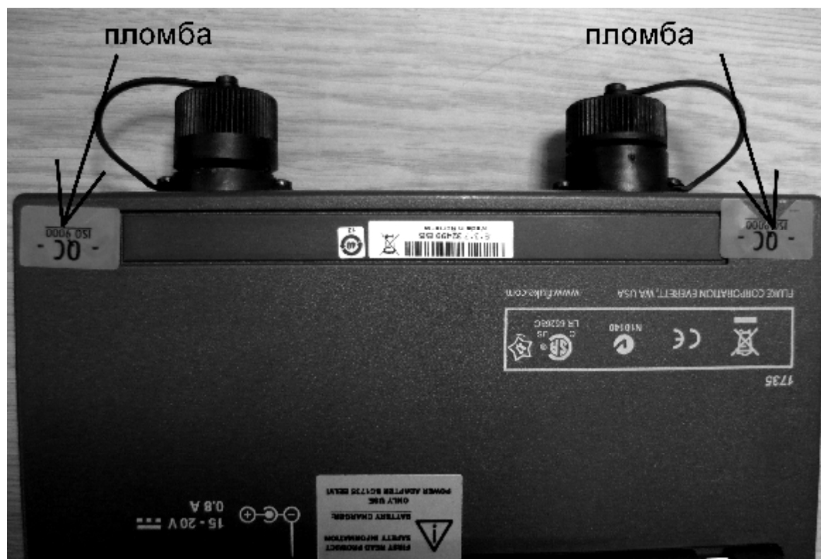
Рисунок 2. Схема пломбирования регистраторов модели Fluke 1735.
