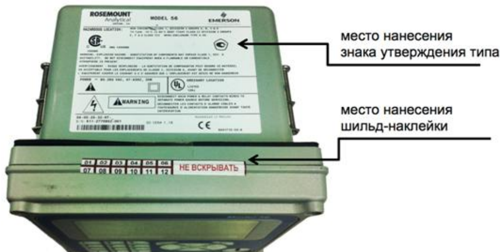
Рисунок 2 – Защита корпуса от несанкционированного доступа
