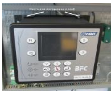
Рис.1 – Внешний вид и схема пломбирования контроллера ВФС.
