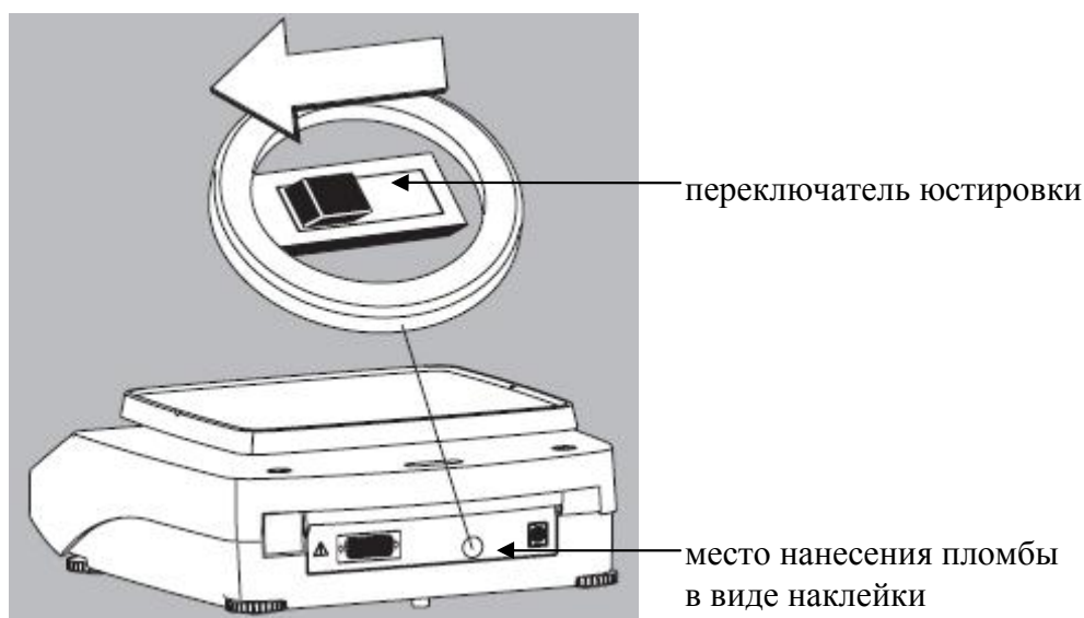
Рисунок 2 - Схема пломбировки от несанкционированного доступа.
