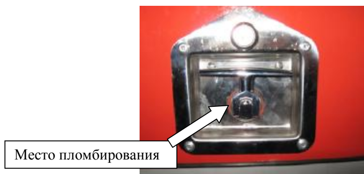
Рисунок 7 – Ручка открывания технологического отсека, или заглушка открывания трубопровода слива топлива из АЦ (в зависимости от конструктивного исполнения)
