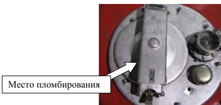
Рисунок 3 - Запорный механизм крышки заливной горловины АЦ
