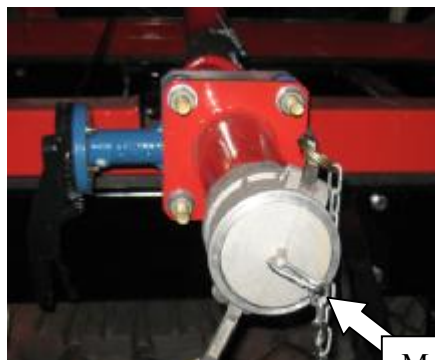
Рисунок 7 – Ручка открывания технологического отсека, или заглушка открывания трубопровода слива топлива из АЦ (в зависимости от конструктивного исполнения)
