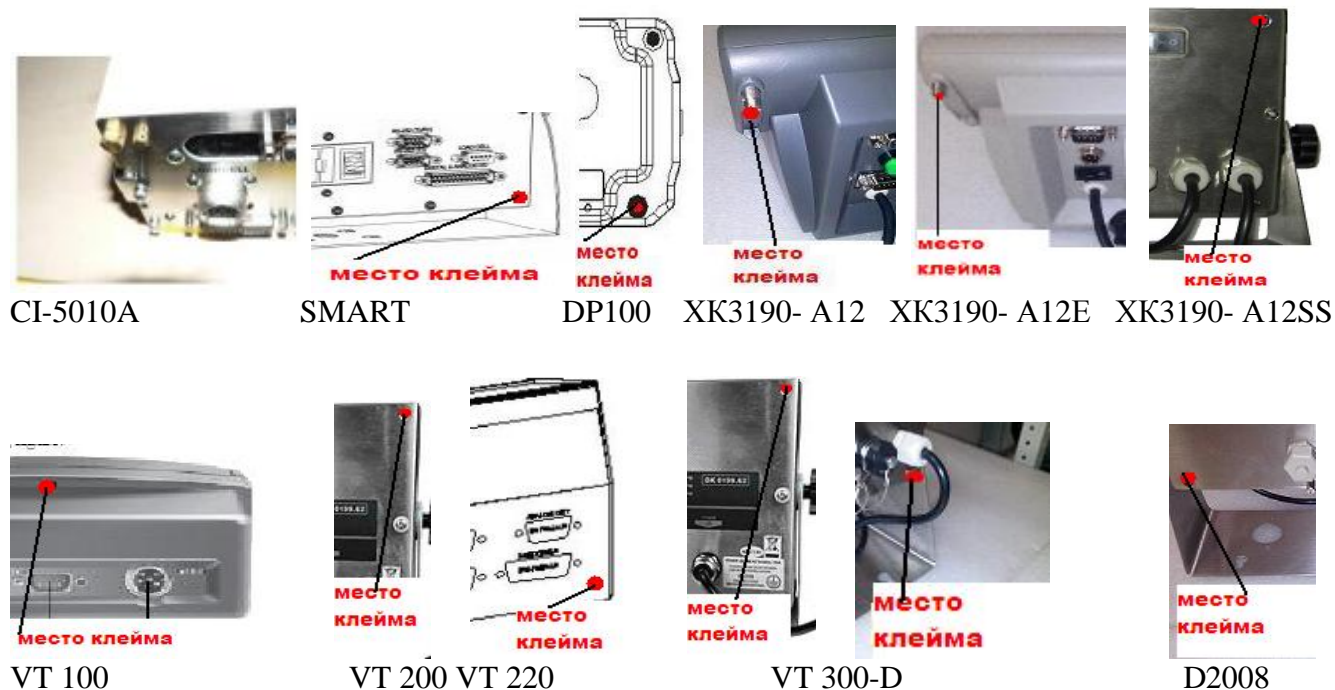
Рисунок 4 Схема пломбировки от несанкционированного доступа и обозначение места для нанесения оттиска клейма.
