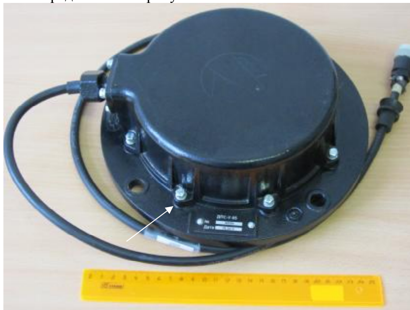
Рисунок 1. Общий вид датчика. Стрелкой отмечено место пломбирования.
