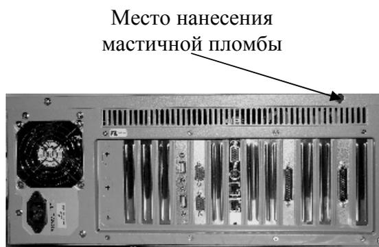
Рисунок 4 - Схема пломбировки индикатора М1РС-01 и терминала М1РС-03
