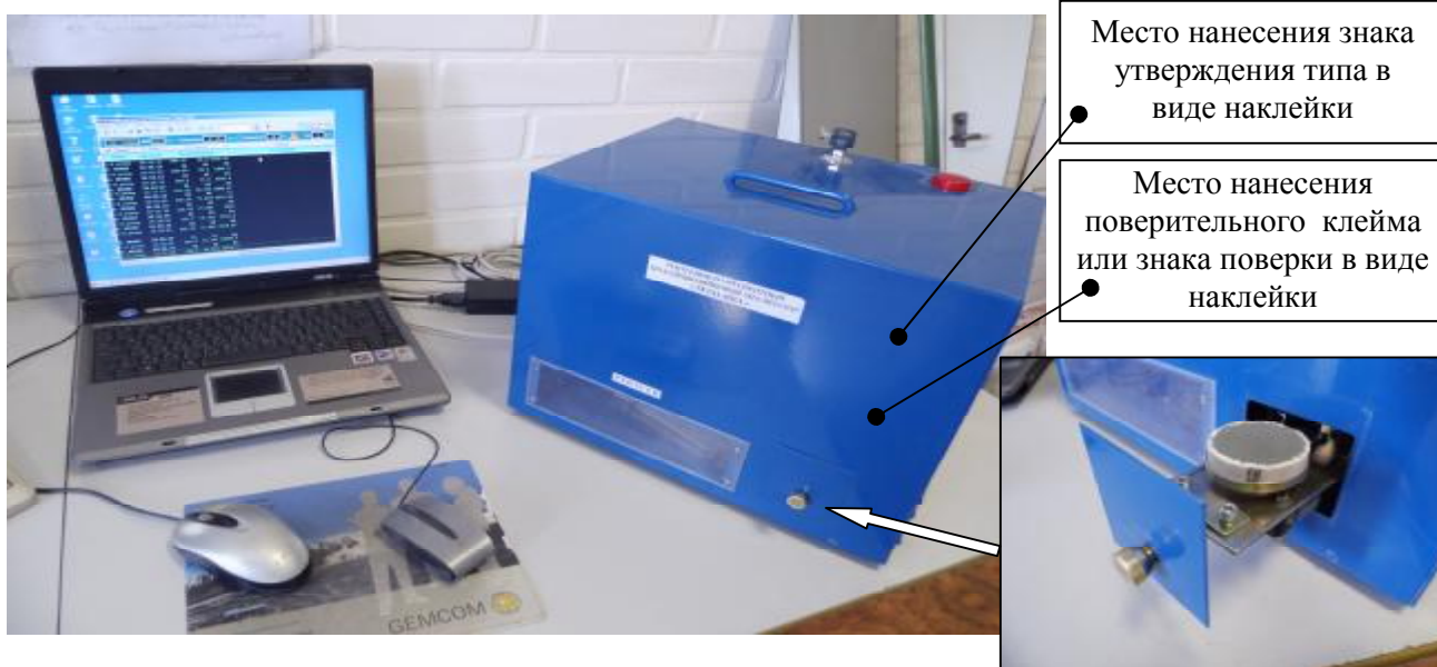
Рисунок 1 – Внешний вид анализатора и устройства подачи образца в зону измерения
