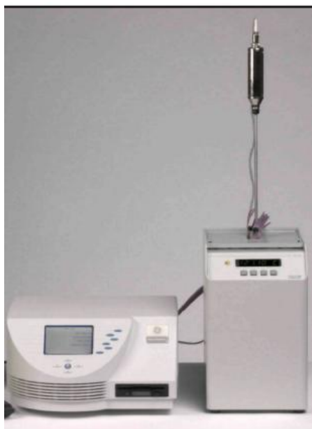
рис.1 Вид установки Kaye Validator (слева направо термомонитор, IRTD в термостате)
