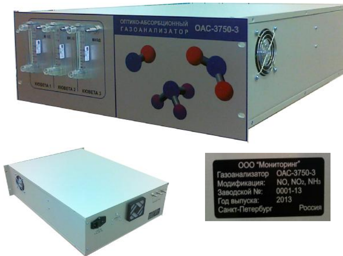
Рисунок 1 – Внешний вид газоанализатора
