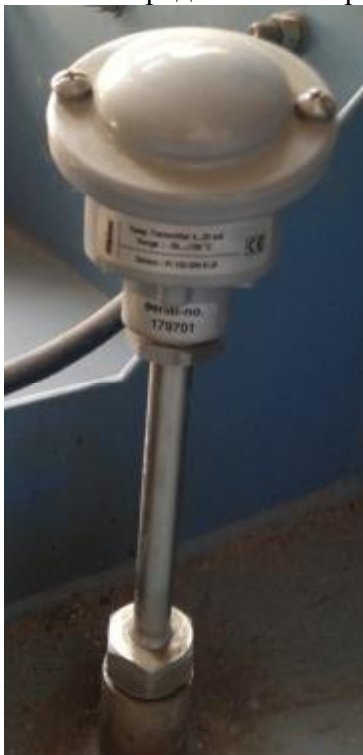
Рис. 1. Внешний вид термопреобразователя сопротивления платинового модели 818.3.
