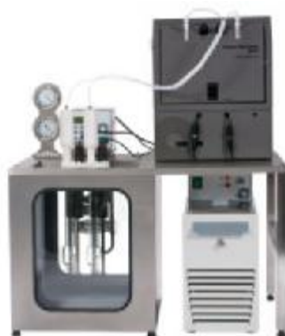
Рис.1 Вид установки измерения вязкости автоматической RPV
