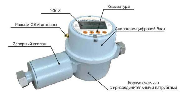
Рисунок 1 - Общий вид счетчиков газа Гранд - SPI
