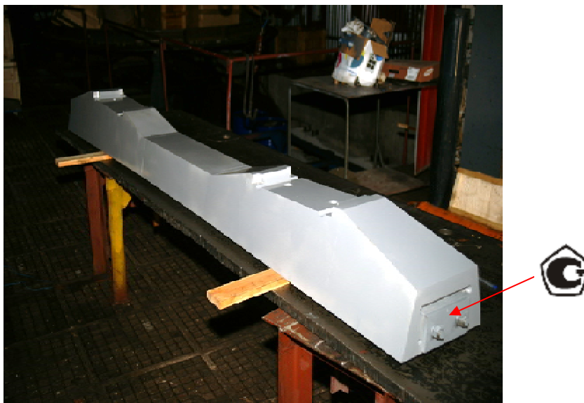
Рисунок 1 – Общий вид мер для поверки систем автоматизированного контроля геометрических параметров железобетонных шпал.
