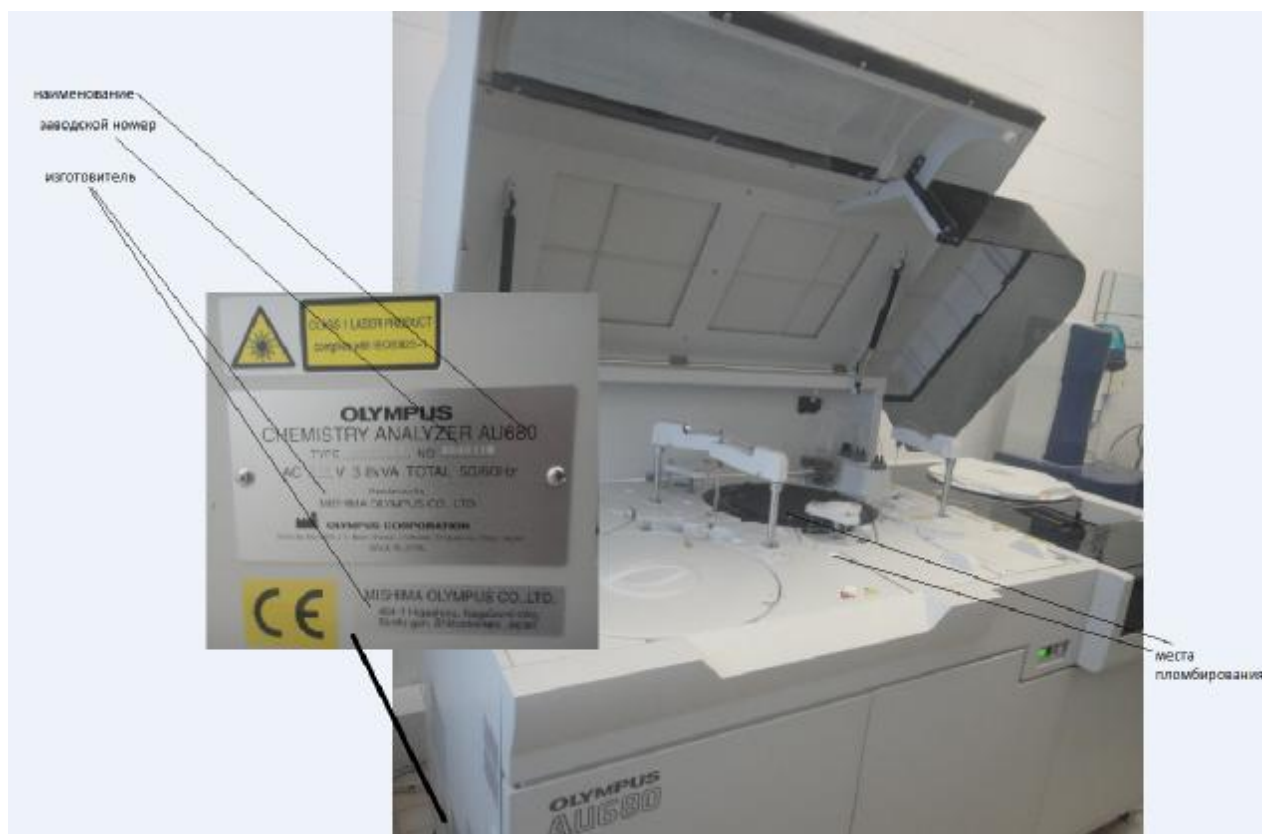
Рисунок 2 – Схема маркировки и пломбировки
