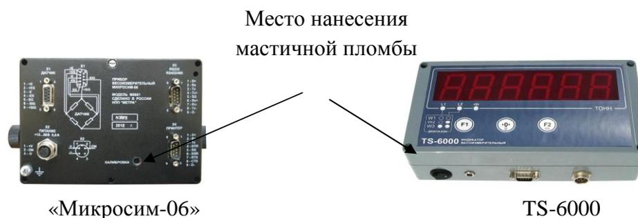
Рисунок 3 – Место пломбировки
