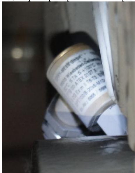
Рис. 1. Термопреобразователь сопротивления платиновый модели 2РТ100/В-20х6-М10х1-2/3.
