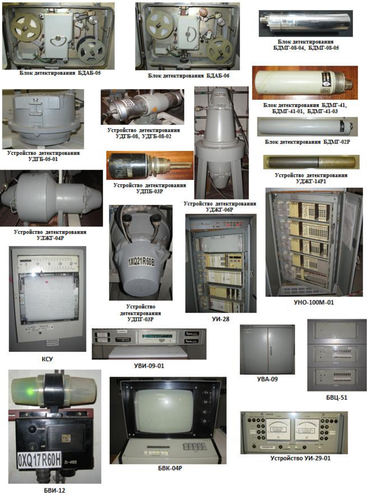
Рис. 3 - Основные технические средства из состава АСРК-1 РоАЭС.
