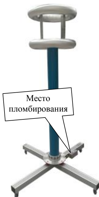
Рисунок 2 – Схема пломбирования делителей
