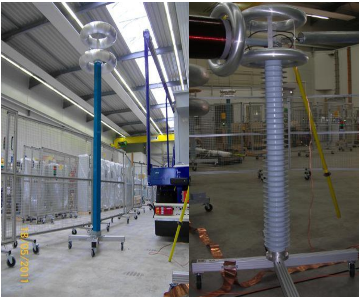
Рисунок 1–Внешний вид делителей напряжения измерительных: а) – типоразмер WC, WCF; б) – типоразмер FWC, FWCF
