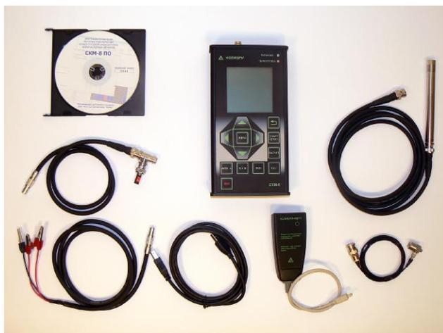
Рисунок 1 – Общий вид концентратора-анализатора низкочастотных сигналов многофункционального СКМ-8
