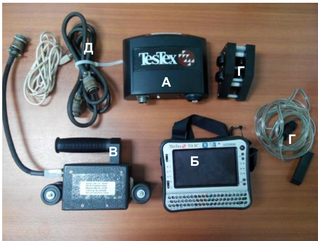
Рисунок 1 - Общий вид дефектоскопов TiS 8C А – электронный блок TiS 8C; Б - компьютер (промышленный мини компьютер); В - сканер; Г – ручной преобразователь; Д – соединительные кабели.
