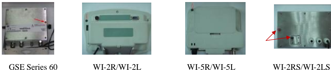
Рисунок 4 Схема пломбировки от несанкционированного доступа и обозначение места для нанесения оттиска клейма.
