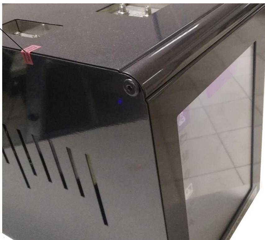
Рисунок 4 – Место пломбирования от несанкционированного доступа хроматографов газовых промышленных серии МАГ в невзрывозащищенном (лабораторном) исполнении (исполнение 2)
