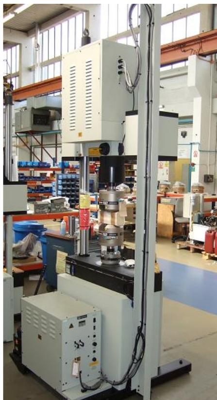
Рис.2 Общий вид машин испытательных 8861-С2 и 8862-С2
