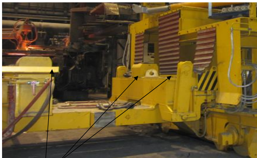
места установки весоизмерительных тензорезисторных датчиков
