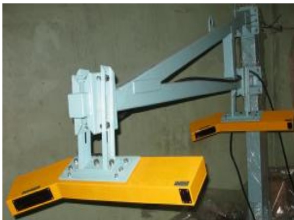
Рисунок 2. Внешний вид двухдиапазонных лазерных профилометров, закрепленных на кронштейне
