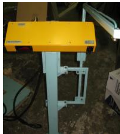
Рисунок 3. Внешний вид однодиапазонного профилометра, расположенного на кронштейне
