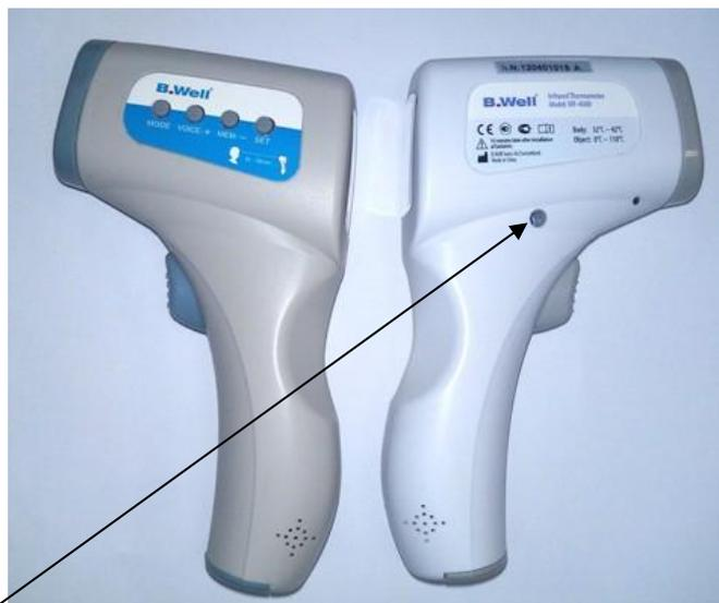
Место пломбировки от несанкционированного доступа
