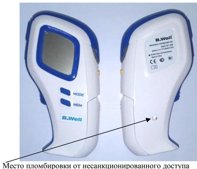
Место пломбировки от несанкционированного доступа
