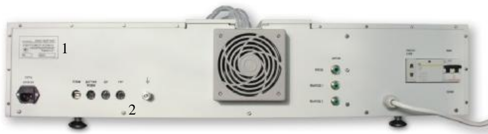
Рисунок 2 – Места нанесения маркировки (1) и пломбирования (2)
