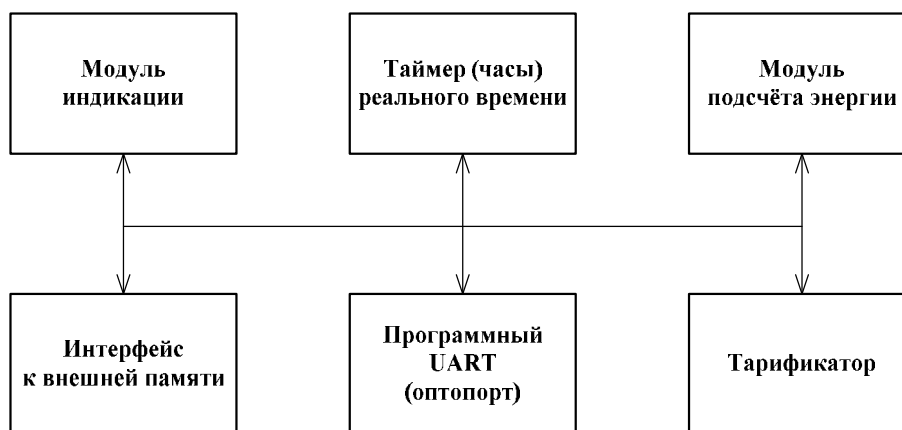
Рисунок 3 - Структура программного обеспечения «Меркурий 203.2Т»
