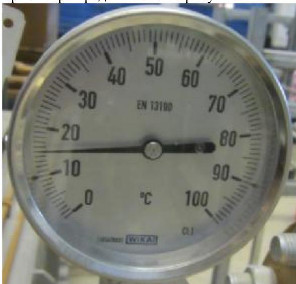
Рис. 1. Внешний вид термометра биметаллического R52.100.
