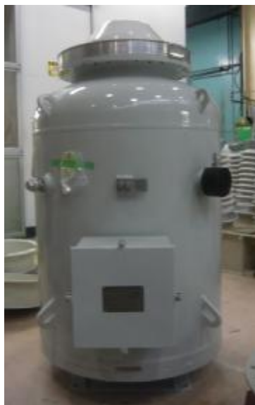
Рисунок 1 – Фотография общего вида трансформаторов напряжения SVR-34C
