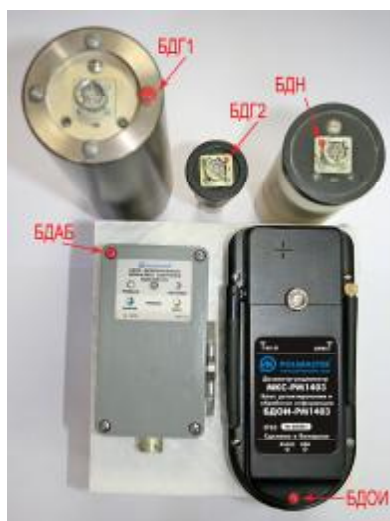
Рисунок 2 – Места пломбирования БДОИ и внешних блоков детектирования
