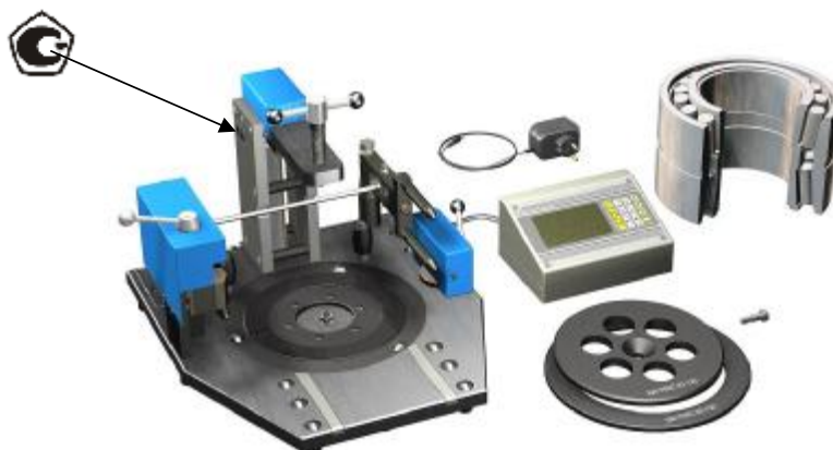
Рисунок 1 - Внешний вид приборов для контроля радиального зазора подшипников модель БВ-7602-33 и место нанесения знака утверждения типа.
