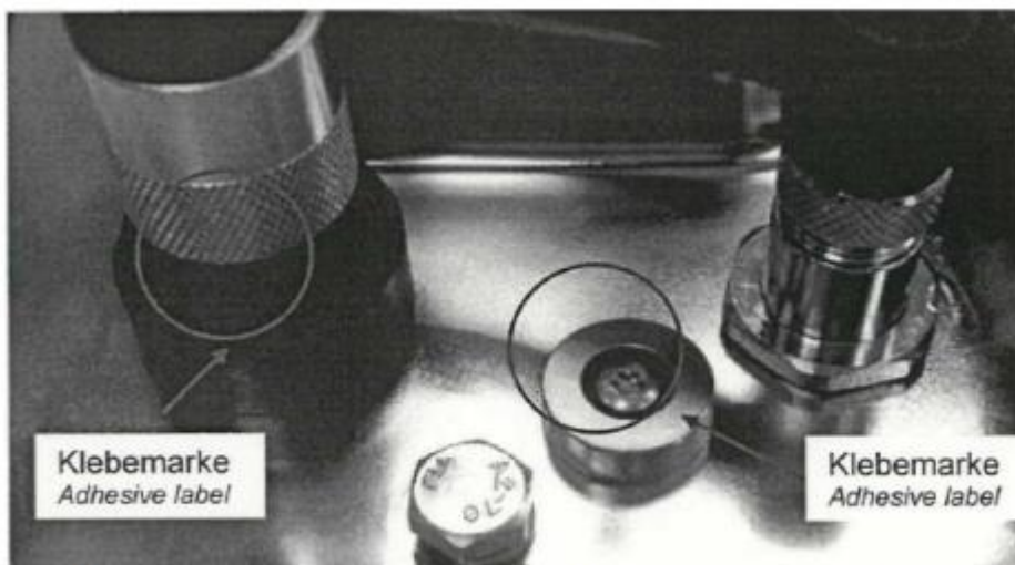
Места пломбировки терминала ICS469 исключающие несанкционированные настройки и вмешательства, которые могут привести к искажению результатов измерений
