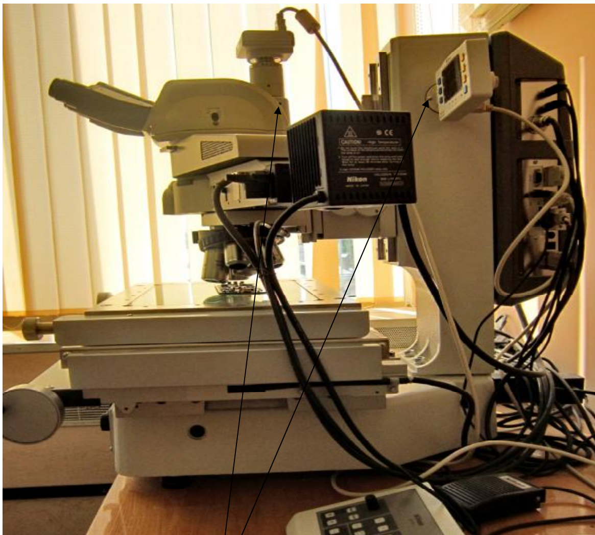
места пломбировки от несанкционированного доступа Рисунок 2 – Общий вид микроскопа Nikon MM-800/LM. Вид сбоку.
