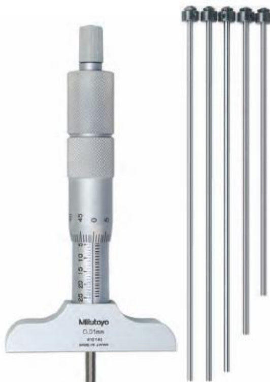
Рисунок 2 - Общий вид глубиномеров микрометрических серии 129 с набором сменных измерительных стержней
